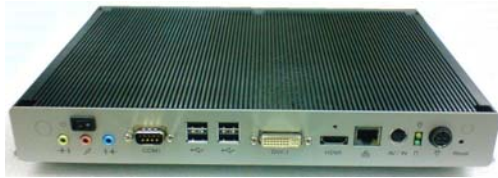
上部の放熱フィン
