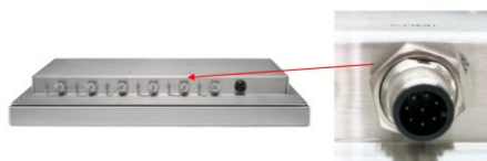
図4. シリアル(RS-232C)ポート DC5V または DC12V を供給することが可能です。
