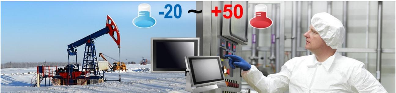
『WTP-8B66-10 W』は台湾 Best Choice で金賞を受賞した『WTP-9A66-19』の技術を継承しており、I/O ポートには M12 の IP68 対応のメタル・キャップを採用し、IP66 対応の完全防塵・防水ステンレス筐体の製品です。但し、『WTP-9A66-19』と最も異なる点は、食品加工の工場などの劣悪環境に耐えられる高範囲動作温度の「 $-20\sim 50^{\circ}\text{C}$ 」に対応している点です。『WTP-8B66-10 W』のマザーボードでは、低消費電力: 10W の「Intel ATOM E3845 CPU」を採用し、広範囲動作温度に耐えられる部品を選定し、ストレージも広範囲動作版の SSD 128GB を標準搭載しております。更に熱処理方法も強化すると共に、零下での運用においては、独自のヒータと BIOS での制御にて動作可能としております。
