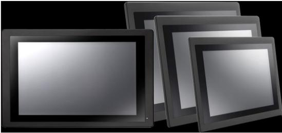
WLP-7D20 シリーズでは CPU 性能の向上に加え、産業用 PC の設計思想も受け継ぎ、従来通りファンレス構造のため、各種の自動制御システム、工作機械や KIOSK 端末など向けに最適な設計となっております。タッチパネルは標準の「5 線式抵抗膜タイプ」とオプションの「投影型静電容量タッチパネル(P-Cap マルチタッチ)」の 2 種類を選択可能です。また、タッチパネル部の前面パネルは表面フル・フラット構造で IP66 対応の防塵・防水性能となっておりますので、画面の清掃も容易となります。
