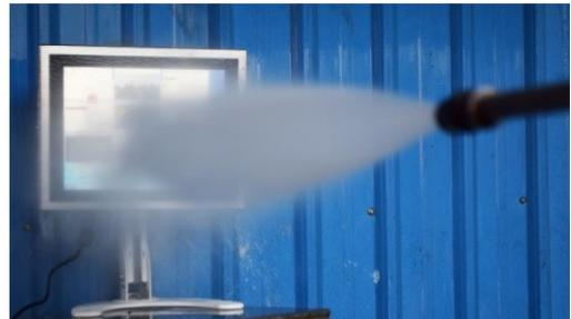
『IP67』は、水深 1m に 30 分間浸水しても有害な影響を受けないことから、更に耐水性が求められる用途に最適となります。『IP66』は一般的な食品加工の生産ライン等で求められるスチームジェット洗浄は可能ですが、『IP69K』では、高圧水流洗浄や高温蒸気洗浄も可能となります。Wincomm の全ての防水対応製品は検証機関にて認証を受けしており、合格証書を保有しておりますが、出荷時にも厳格な圧力試験にて 100%の防水性能を確認し、Wincomm 独自の防水技術によって 100%の防水を保証しております。
