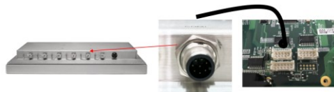
図 4: マザーボードの DC5V または DC12V の出力を RS-232 シリアル・ポートの未使用信号ラインに出力
